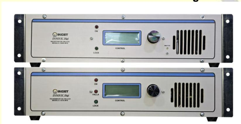
El IGTE-M15/IGRE-M15 digital es el conjunto formado por un transmisor y un receptor de radio enlaces en Banda de 300 a 330 Mhz. El transmisor de 10W Es sintetizado programable por medio de microprocesador y al igual que el receptor va en pasos de 100Khz por toda la banda descrita. La Visualización de frecuencia, potencia, nivel de recepción y El nivel de modulación, se visualiza por medio de LCD en los Frontales.
